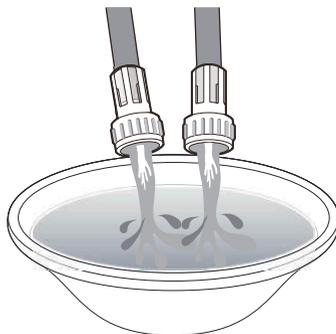
4. Connecter les extrémités des tuyaux d'eau aux connexions de la prise d'eau au dos de la laveuse. Le tuyau d'alimentation en eau connecté au robinet d'eau chaude doit être connecté à l'admission d'eau chaude et le tuyau d'eau connecté au tuyau d'eau froide doit être connecté à l'admission d'eau froide.
