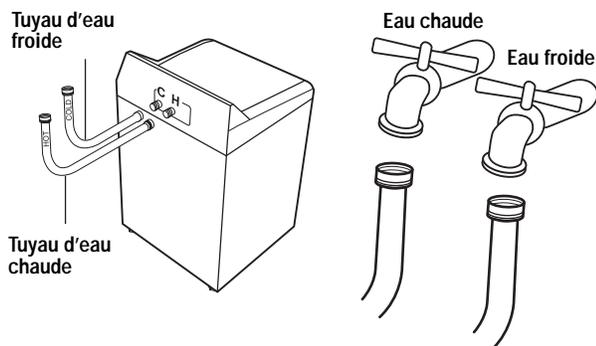
5. Serrez chaque raccord à la main, puis serrez de 2/3 de tour avec une pince. Ne faussez pas les filetages et ne serrez pas trop ces raccords.
