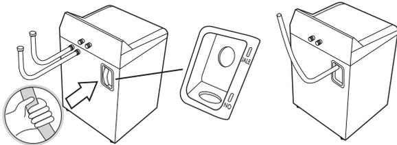
2. Faites couler de l'eau des robinets d'eau chaude et d'eau froide afin de rincer les tuyaux d'alimentation en eau et d'enlever les particules qui pourraient obstruer les filtres des robinets d'eau.
