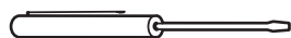
Petit tournevis à tête plate (pointe de 2 à 2,4 mm ou 3/32", 60 mm de longueur)
