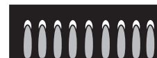
(B) Puntas amarillas en conos externos — Normal para el gas propano (LP)
