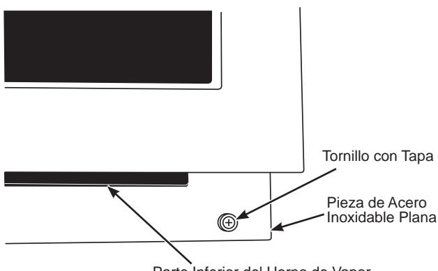
3. Asegúrese de que la pieza de acero inoxidable plana tenga contacto con la parte inferior del horno de vapor antes de asegurar la misma al gabinete. Si se instalará al lado de otro electrodoméstico, asegúrese de que las partes inferiores con bordes se alineen antes de ajustar los tornillos al gabinete.
