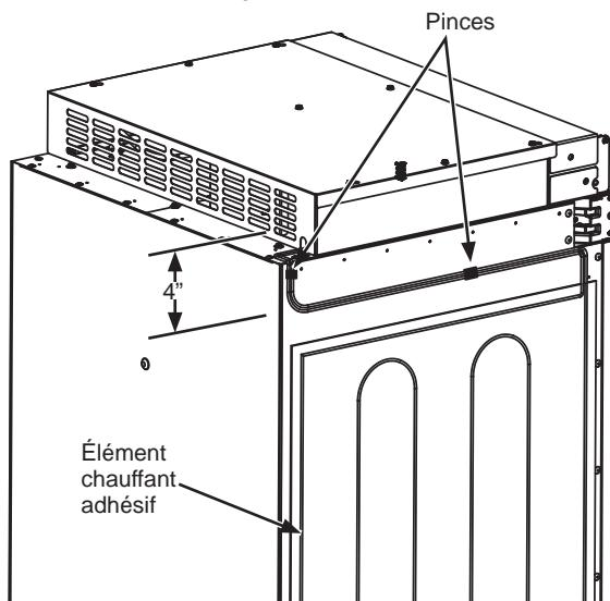
**REMARQUE :** L'installation de l'élément chauffant est possible seulement à la gauche des modèles compatibles.
