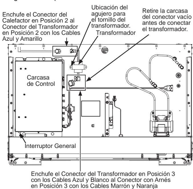
El ensamblaje adjunto que aparece más arriba se muestra con la tapa retirada.
