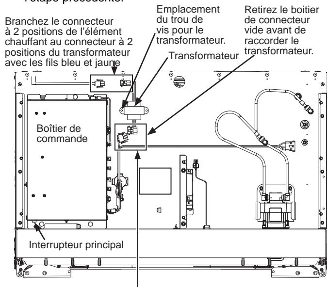
Branchez le connecteur à 3 positions du transformateur avec les fils noir et blanc sur le connecteur à 3 positions du faisceau avec les fils brun et orange
