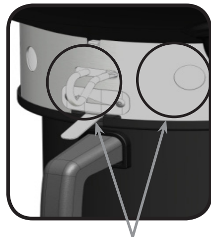
Sluiten Ventilatie Openingen
