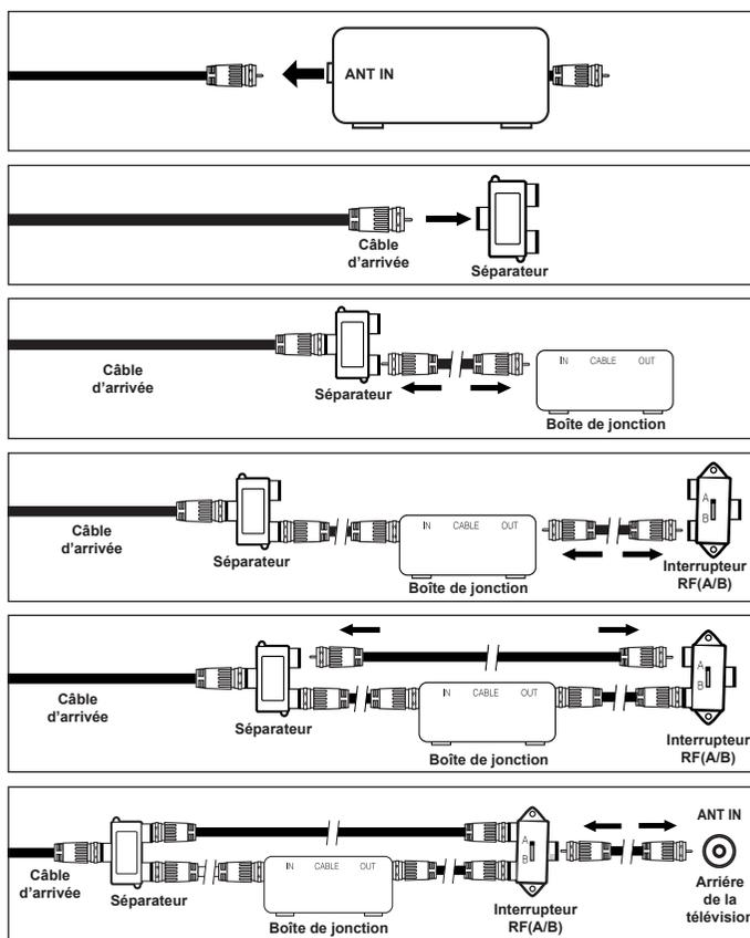
Après avoir établi cette connexion, réglez l'interrupteur A/B en position "A" pour regarder les canal normales. Placez l'interrupteur A/B en position "B" pour une regarder les canal cryptées. (Lorsque vous placez l'interrupteur A/B sur "B", vous devez syntoniser votre télévision sur la canal de sortie de la boîte de jonction qui est habituellement la canal 3 ou 4.)
