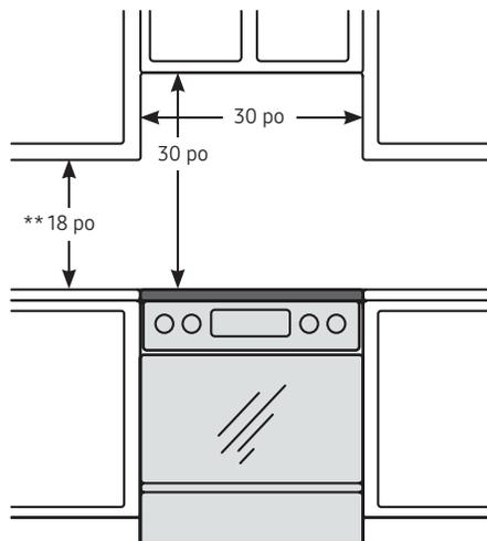
**IMPORTANT :** Comme il y a risque de brûlure ou d'incendie lorsqu'une personne s'étire au-dessus d'une surface de cuisson chaude, l'installation d'une armoire au-dessus de la surface de cuisson est à éviter. Si une armoire y est installée, le risque peut être réduit en installant une hotte de cuisinière avec un surplomb d'au moins 5 po au-delà du dessous de l'armoire.
