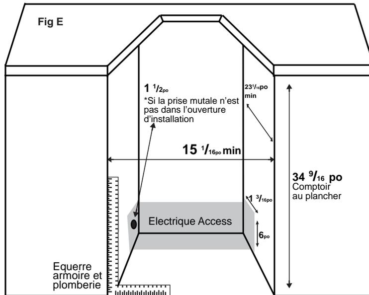
Important : Le requirement de profondeur pour l'installation suppose que la prise murale est localisée dans une autre armoire ou est monté dans le mur, pas monté sur la surface dedans l'ouverture.
