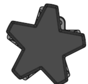
Posicionamiento incorrecto de la tapa del quemador
