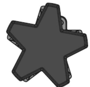
Positionnement incorrect de la cuvette du brûleur
