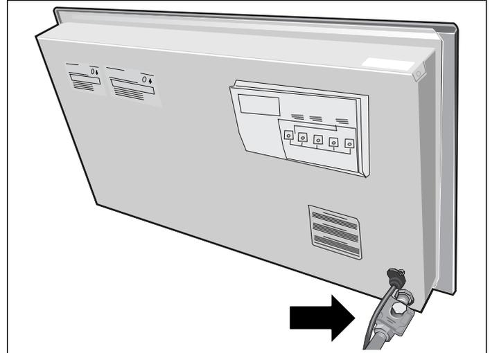
1. Retirar el tapón hexagonal del regulador asegurándose de no sacar la junta del tapón o el muelle de dentro del regulador.
