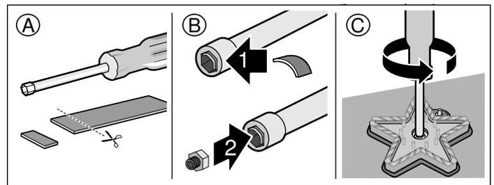
**Nota:** Guardar las espreas para gas natural por si más tarde hiciera falta volver a convertir el aparato para utilizarlo con gas natural.
