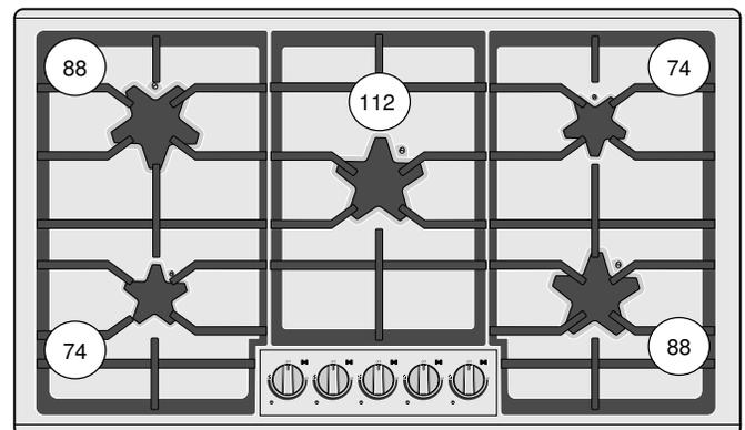
Les diamètres des ports sont indiqués dans les cercles blancs et correspondent à chaque brûleur illustré dans l'image ci-dessus. Ces chiffres sont gravés sur le côté de chaque port. Il est très important d'installer le bon diamètre de port pour chacun des brûleurs.
