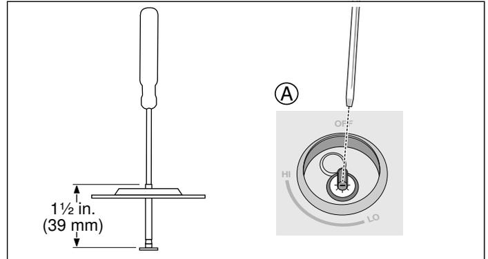
4. Insérer l'extrémité du tournevis dans la vis de réglage et tourner lentement le tournevis pour sentir l'insertion de la lame dans la vis. Puis tourner la vis dans le sens horaire sur près de 70 degrés (moins de 1/4 de tour) jusqu'à ce qu'il soit au fond (la vis ne tourne plus). Il ne faut pas beaucoup de force pour faire tourner la vis. Cesser de visser dès que la vis cesse de tourner. Ne pas trop la serrer. Recommencer pour chacun des robinets jusqu'à ce qu'ils soient tous bien réglés.
