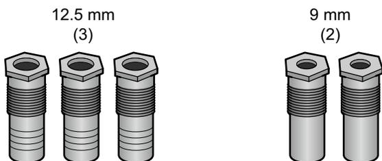
**Remarque :** Selon le modèle, il est possible que la trousse ait plus de venturis et de ports que nécessaire pour effectuer la conversion de l'appareil électroménager.
