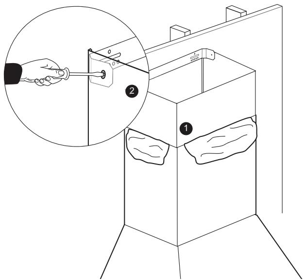
7. A partir del interior de la campana, atornille los tornillos para chapa de 5/8 pulg. (16 mm) proporcionados a través de los agujeros de cada lado y de la parte delantera del alargador. La cantidad de tornillos depende del tamaño de la campana.
