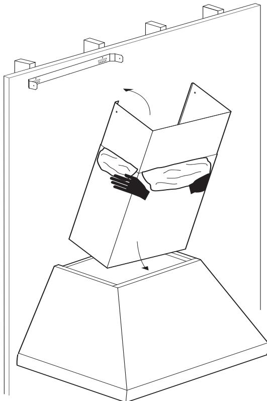
6. Empuje cuidadosamente la parte superior del alargador hacia arriba. Atornille los lados izquierdo y derecho del alargador al soporte de montaje con los tornillos para acero inoxidable proporcionados.
