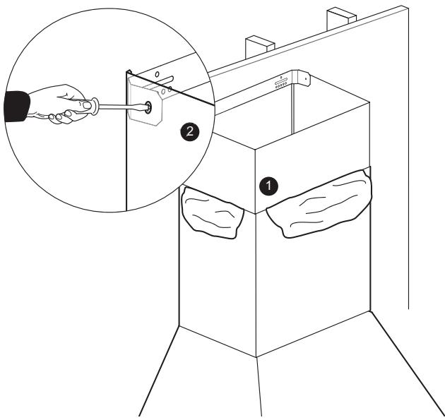
7. À partir de l'intérieur, vissez à travers les trous latéraux et avant les vis à tôle de 5/8 po (16 mm) fournies dans le bas de la rallonge. La quantité de vis fournies dépend des dimensions de la hotte.
