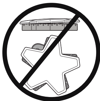
Tapa del quemador incorrecta
