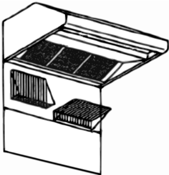
FIGURE 14: DOSSERET DE PROTECTION AVEC ÉTAGÈRE GARDE-CHAUD
