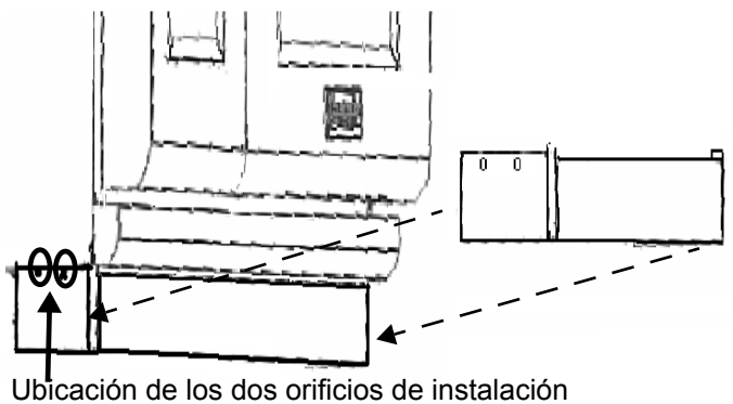
Figura 26: Instalación del rodapié
