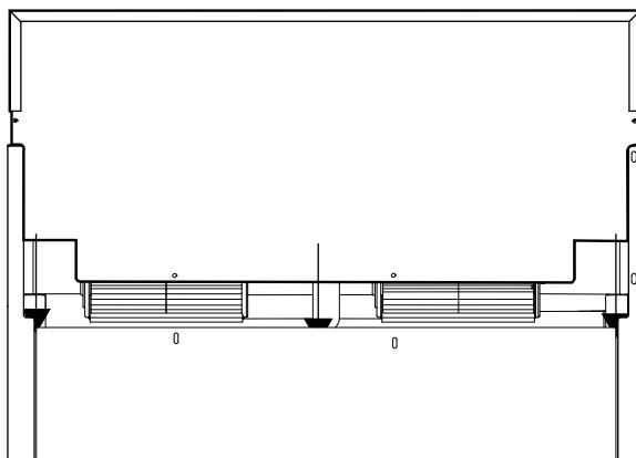
4. Asegúrese de que la parte frontal de la consola esté fuera de la pestaña en la parte delantera de la estufa.
