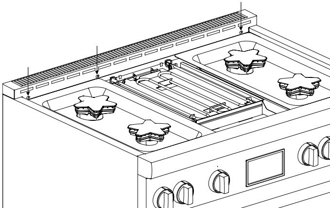
2. Quite los cuatro tornillos de punta que retienen el adorno a los paneles laterales y los dos o cuatro tornillos de punta que retienen la placa trasera en su sitio. Levante el adorno para quitarlo totalmente.
