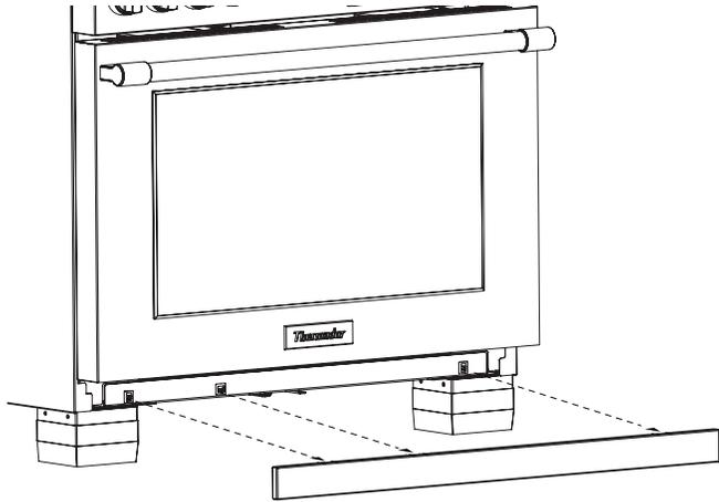
2. Retire las cubiertas plásticas protectoras de la zona del zoclo y el panel de ajuste deslizante.
