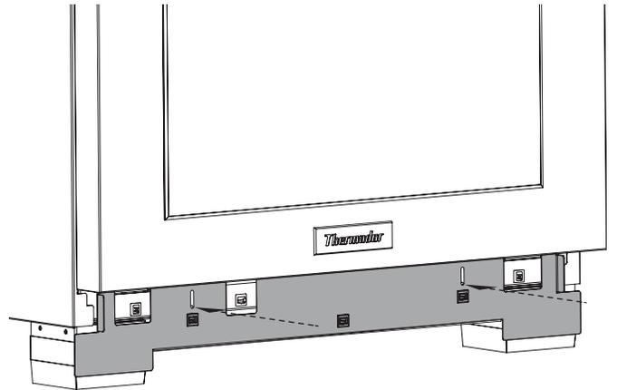
4. Presionar el panel de protección inferior en los clips de montaje.
