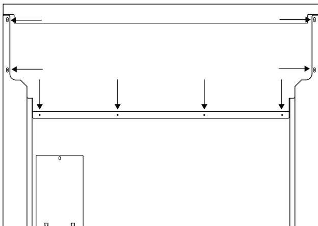
3. Alinee el panel trasero del nuevo accesorio con las pestañas de los rincones de izquierda y derecha de los paneles laterales. La consola trasera se inserta en los canales guías situados detrás de la estufa.
