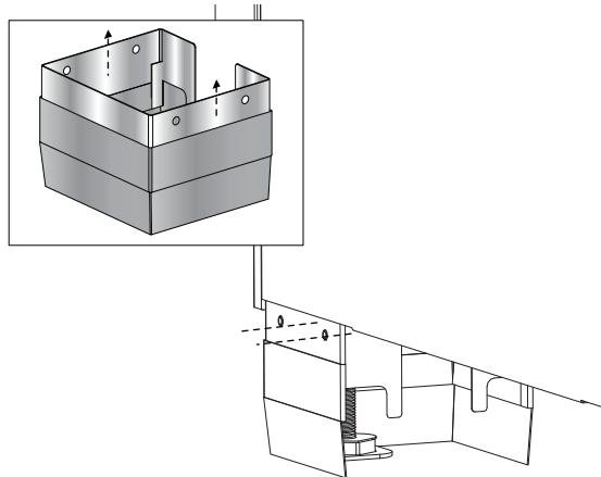
2. Retirar las cubiertas de las patas deslizando la parte superior, la funda exterior de las cubiertas de las patas fuera de los hoyuelos extruidos de la base.
