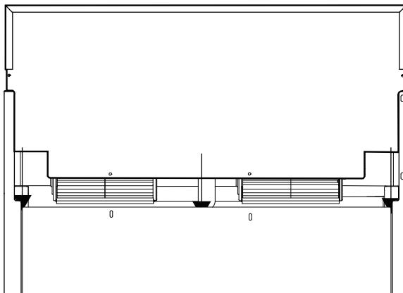
4. Asegúrese de que la parte frontal de la consola esté fuera de la pestaña en la parte delantera de la estufa.
