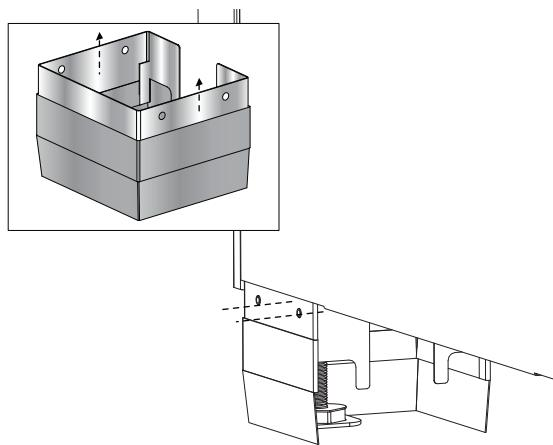
2. Retirez les protège-pattes en glissant le manchon extérieur supérieur hors des alvéoles extrudées du socle.
