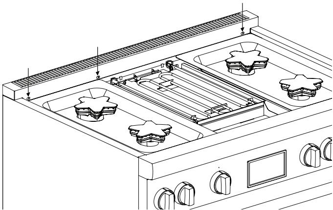
2. Quite los tornillos de punta que retienen el adorno a los paneles laterales y los dos o cuatro tornillos de punta que retienen la placa trasera en su sitio. Levante el adorno para quitarlo totalmente.
