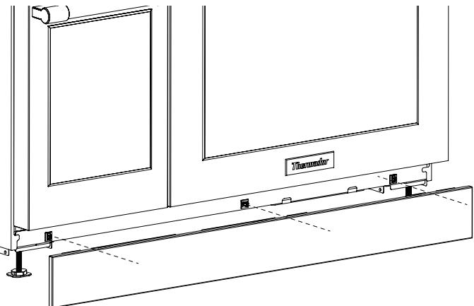
**NOTA:** La parte de acoplamiento tiene hoyuelos extruidos en ambos lados, por lo que los orificios del panel de protección inferior deberían detenerse. Se debe sentir un chasquido definitivo, haciéndole saber que la parte ha sido instalada.
