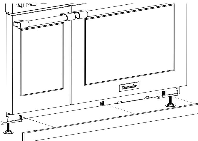
3. Presionar el panel de protección inferior en los clips de montaje.
