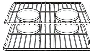
Placement des plaques sur plusieurs grilles
