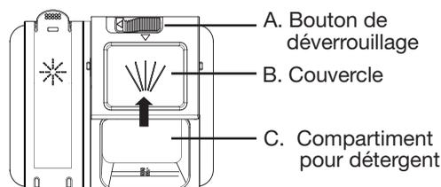
Fermer le distributeur de détergent en faisant glisser le couvercle (B) sur le compartiment à détergent (C).
