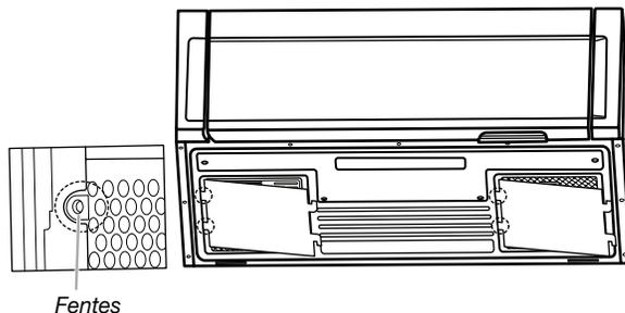
4. Replacer le filtre à graisse sur la plaque inférieure.
