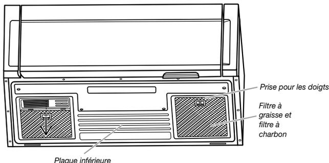
2. Nettoyer le filtre à graisse tous les mois ou le remplacer par un nouveau filtre à graisse si nécessaire.
