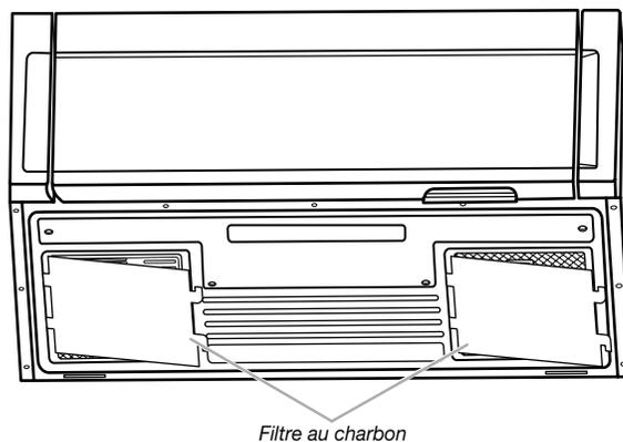
3. Replacer un nouveau filtre au charbon et le fixer à la plaque inférieure. S'assurer que les côtés gauche et droit sont bien insérés dans les fentes de la plaque inférieure.
