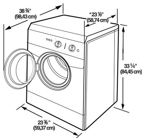
\*La plupart des installations nécessitent un dégagement minimum de 4" (10,16 cm) derrière la laveuse pour le dégagement du tuyau d'évacuation. Voir "Système de vidange".
