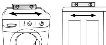
4. Si la laveuse n'est pas de niveau, relever l'avant à l'aide d'une cale de bois et ajuster le déploiement des pieds vers le haut ou vers le bas selon le besoin. Si la laveuse est placée contre un mur, on doit l'écartier légèrement du mur avant de l'incliner vers l'arrière. Répéter ces opérations jusqu'à l'obtention d'un aplomb correct de la laveuse.
