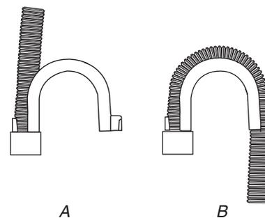
A. Emboîter une des extrémités de la bride de formage en U sur le tuyau d'évacuation, au point de départ des ondulations.
