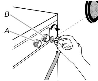
A. Valve du tuyau d'alimentation d'eau froide
