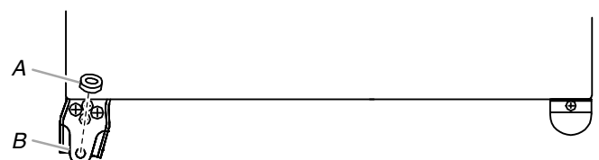
A. Bottom hinge washer B. Bottom hinge
