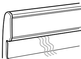
L'évent du four permet l'évacuation de l'air chaud et de l'humidité du four et ne doit pas être obstrué ou couvert. Le fait d'obstruer ou de couvrir l'évent nuit à la circulation adéquate de l'air et affecte les résultats de cuisson et de nettoyage. Ne pas placer près de l'évent du four des produits en plastique, en papier ou d'autres articles qui pourraient fondre ou brûler.
