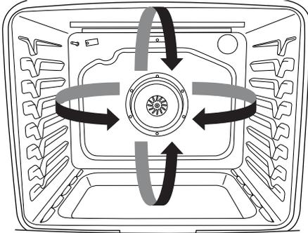
Durant la cuisson par convection, les éléments de cuisson au four, cuisson au gril et cuisson par convection s'allument et s'éteignent par intermittence pour maintenir la température du four tandis que le ventilateur fait circuler l'air chaud.
