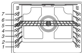
Le four a 7 positions pour une grille plate, comme indiquées dans l'illustration précédente et le tableau suivant.
