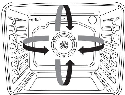
Durant la cuisson par convection, les éléments de cuisson au four, cuisson au grill et cuisson par convection s'allument et s'éteignent par intermittence pour maintenir la température du four tandis que le ventilateur fait circuler l'air chaud.
