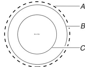
A. Dépassement maximal de  $\frac{1}{2}$ " (1,3 cm)
