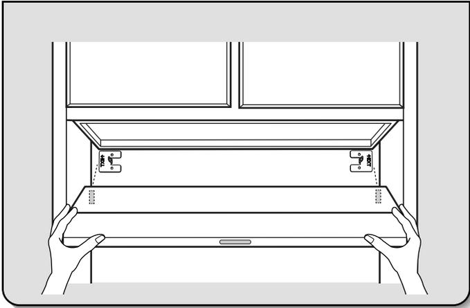
Remettre la hotte en place et insérer les pattes des brides de montage dans les fentes situées à l'arrière de la hotte.
