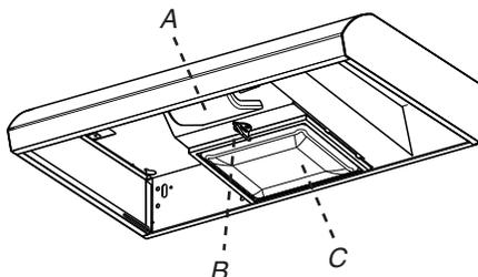
A. Logement et protège-ampoule de l'ampoule à incandescence
