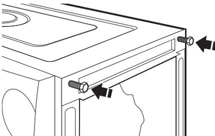
5. Faire glisser le piédestal sur la laveuse et la sécheuse tout-en-un en engageant les boulons dans les fentes situées sur la partie supérieure du piédestal.
