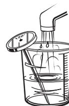
3. Vérifier la température sur le thermomètre pendant que l'eau coule dans la tasse.
