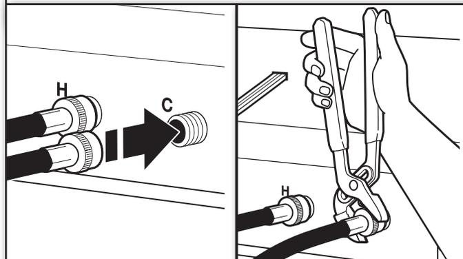
Fixer le tuyau d'eau chaude au robinet d'arrivée d'eau chaude. Visser le raccord à la main jusqu'à ce qu'il soit bien serré. Serrer les raccords de deux tiers de tour supplémentaires à l'aide d'une pince. Répéter pour le robinet d'eau froide. Les deux tuyaux doivent être raccordés pour que la laveuse fonctionne correctement.
