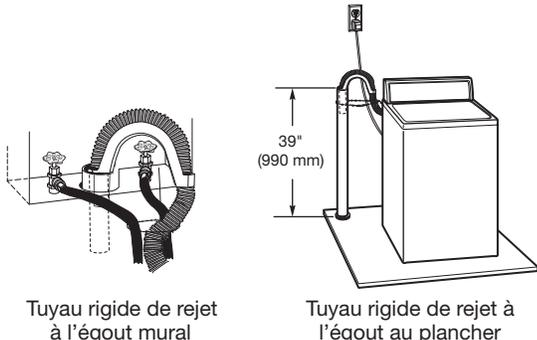
Le système de rejet à l'égout nécessite un tuyau de diamètre minimum de 2" (51 mm). La capacité minimale d'acheminement ne doit pas être inférieure à 17 gal. (64 L) par minute. Un adaptateur de 2" (51 mm) à 1" (25 mm) de diamètre est disponible pour le tuyau de rejet à l'égout. Voir "Outillage et pièces".
