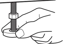
Pour les laveuses avec un pied avant droit réglable, abaisser le pied avant droit jusqu'à ce qu'il soit en contact avec le plancher. À l'aide d'une pince, faire pivoter le pied vers le haut d'un tour et demi supplémentaire.
