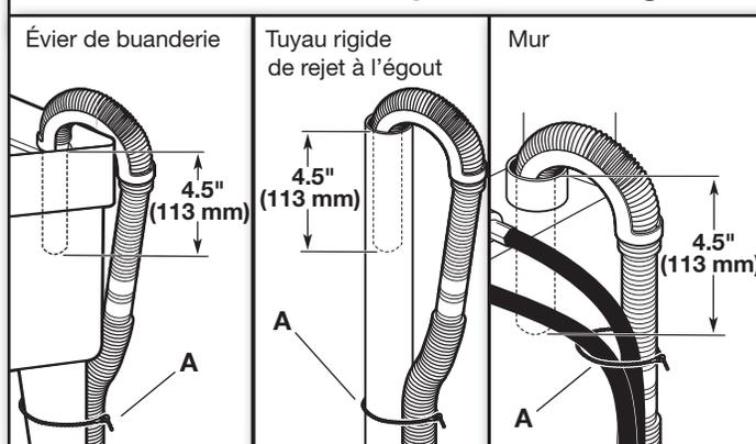
Fixer le tuyau d'évacuation au pied de l'évier de buanderie, au tuyau rigide de rejet à l'égout ou aux tuyaux d'arrivée d'eau pour le tuyau de rejet à l'égout mural avec l'attache de fixation amovible (A). Ceci aidera à réduire le risque d'éclaboussement d'eau sur le plancher.
