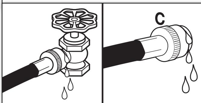
Ouvrir les deux robinets pour vérifier l'absence de fuite au niveau du robinet et du raccordement des rondelles. Une petite quantité d'eau peut entrer dans la laveuse. Vous effectuerez une vidange lors d'une étape ultérieure.
