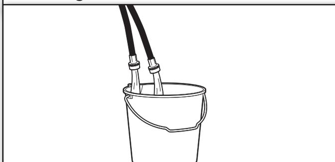
Faire couler de l'eau dans les tuyaux de l'évier de buanderie, le tuyau rigide de rejet à l'égout ou le seau pendant quelques secondes pour éviter toute obstruction. On doit laisser couler l'eau jusqu'à ce qu'elle soit limpide. Vérifier la température de l'eau pour s'assurer que le tuyau d'eau chaude est connecté au robinet d'eau chaude et que le tuyau d'eau froide est connecté au robinet d'eau froide.
