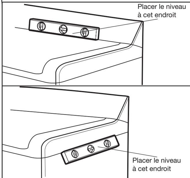
Vérifier le bon aplomb de la laveuse. Placer d'abord un niveau sur le couvercle près de la console. Puis, placer le niveau sur le côté de la laveuse dans l'espace situé entre la partie supérieure de la laveuse et la caisse.
