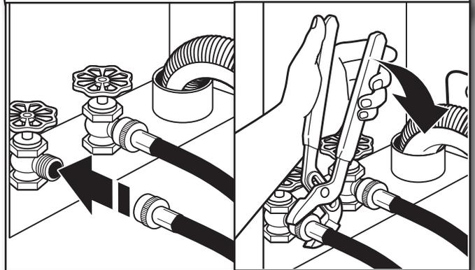
S'assurer que le panier de la laveuse est vide. Fixer le tuyau dont l'étiquette porte la mention "hot" (chaud) au robinet d'eau chaude. Visser le raccord à la main pour qu'il repose sur la rondelle. Serrer les raccords de deux tiers de tour supplémentaires à l'aide d'une pince. Répéter cette étape avec le tuyau portant la mention « cold » (froide) pour le robinet d'eau froide. Les deux tuyaux doivent être raccordés pour que la laveuse fonctionne correctement.
