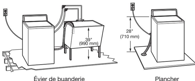
Le système de vidange doit comporter un évier de buanderie d'une capacité minimale de 20 gal. (76 L). Le sommet de l'évier doit être au moins à 39" (990 mm) au-dessus du sol et au maximum à 96" (2,4 m) de la base de la laveuse.
